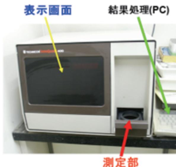
写真1 近赤外分枝測定法（非破壊測定法）
