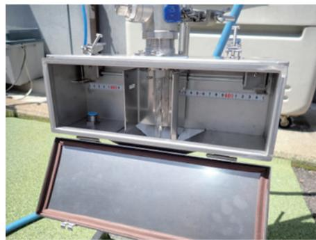
図7 MLSS濃度自動調節装置の濃度測定部（外観と内部構造）
